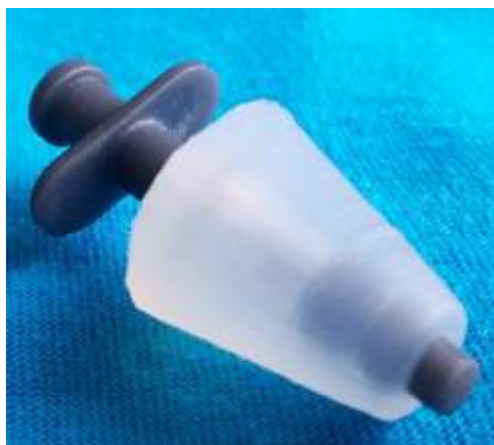
Рис. 4. Лабораторний зразок назальної насадки одноразової для транспортування мукоадгезивних гелів
